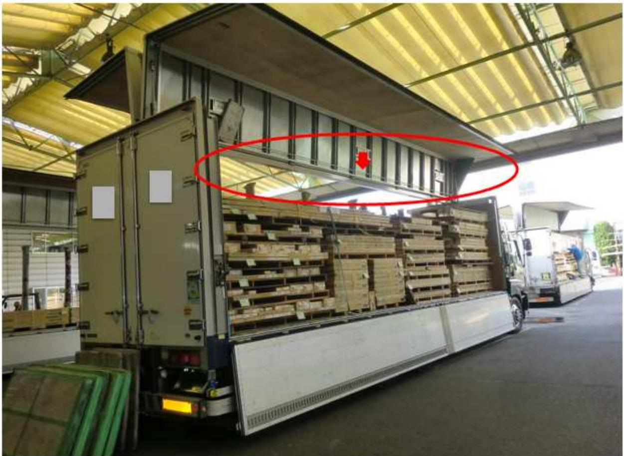
墜落制止用器具を使用できるように、ウイング車に鋼管で専用の設備を設置した事例
